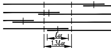
图10.2 钢筋绑扎搭接接头的布置 (本图接头面积百分率为50%)
